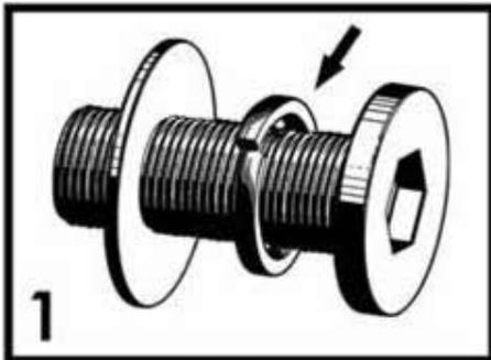
1 Avant de serrer chacune des vis, assurez-vous que la petite rondelle de blocage se trouve en la rondelle plus large et la tête de la vis.
