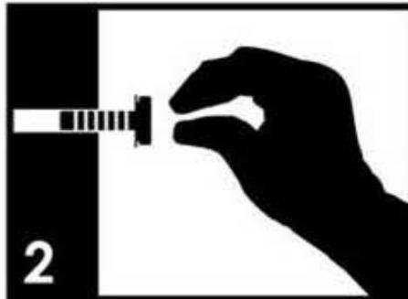
2 Positionnez correctement chacune des pièces et insérez les vis dans leurs orifices respectifs. Puis serrez à la main seulement jusqu'à 70 %. Resserrement complète avec les outils viendra à une étape ultérieure.
