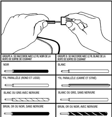
\*Lorsque les fils parallèles sont employés, le fil repère est carré et strié et l'autre fil est rond et lisse (ces caractéristiques s'observent plus facilement du bout du fil). Pour séparer les fils, agrippez le bout de chacun d'eux et tirez en directions opposées.
