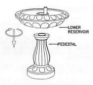
FEED THE PUMP POWER CORD THROUGH THE PLASTIC TUBE TOWARD BOTTOM OF PEDESTAL, CORD EXIT OUT FROM CHANNEL ON THE BOTTOM OF THE BASE.
