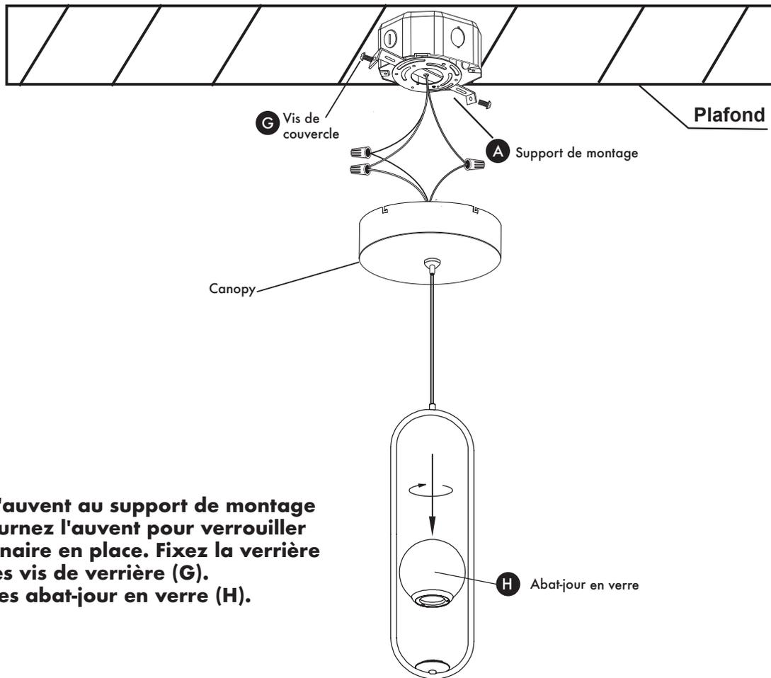
Fixez l'auvent au support de montage (A). Tournez l'auvent pour verrouiller le luminaire en place. Fixez la verrière avec les vis de verrière (G). Fixez les abat-jour en verre (H).
