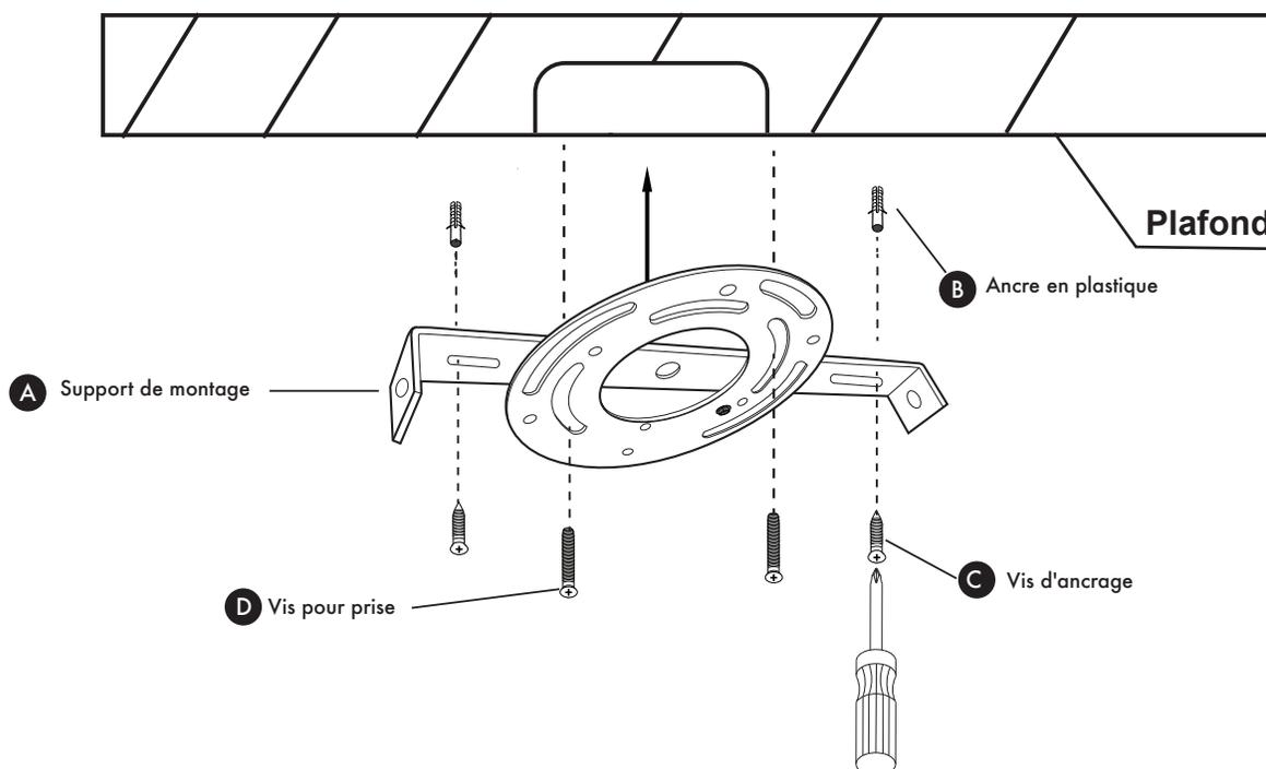
**Fixez le support de montage (A) à la boîte de sortie avec les vis de sortie (D). Vissez les vis d'ancrage (C) dans les ancrages en plastique (B) pour fixer le support de montage (A).**
