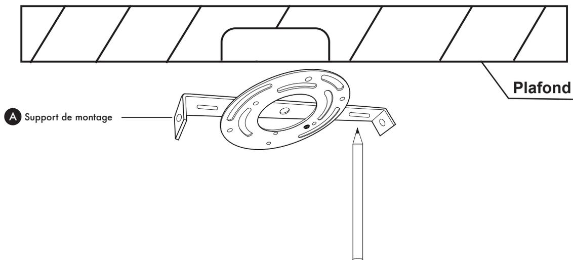
**Soulevez le support de montage (A) au plafond. Marquez l'emplacement des ancrages en plastique (B). Percez des trous pour les chevilles en plastique (B). Insérez les chevilles en plastique (B) dans le trou.**
