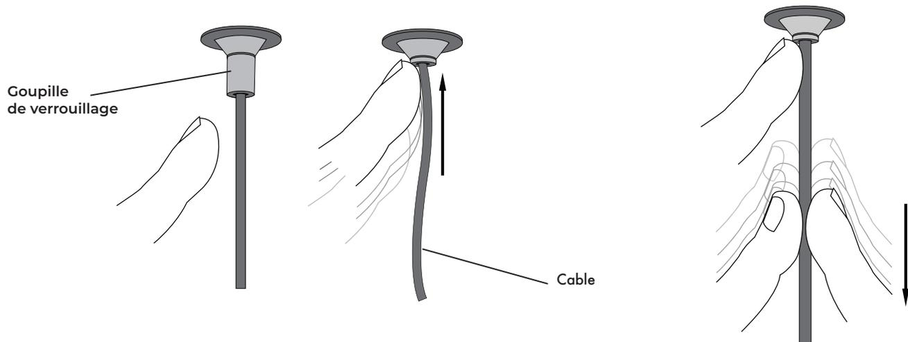
**La longueur du câble est réglable. Afin d'établir la longueur correcte du luminaire, pressez le couvercle du luminaire vers le haut contre le boîtier de sortie dans le plafond pour ajuster la longueur du câble.**
