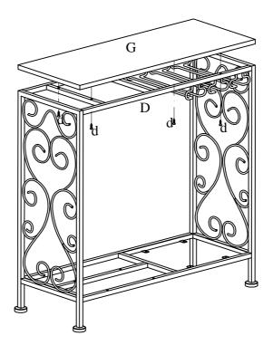
Assemble Top Panel (G) to Top Frame (D) using Screws (d).
