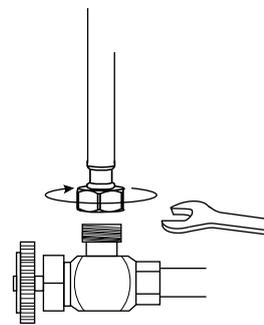
Raccordez les conduites d'eau chaude et froide au tuyau d'entrée et serrez-les bien à l'aide d'une clé. Ne pas trop serrer.
