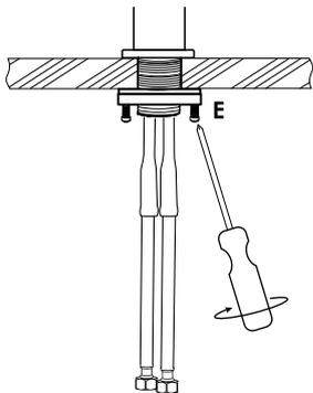
Faites glisser la rondelle et vissez l'écrou de montage sur l'enveloppe fileté. Tournez le robinet vers la position désirée. Serrez fermement la poignée. Serrez fermement les vis de serrage (E).
