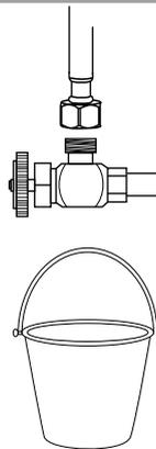
Avant de brancher le tuyau d'alimentation, rincez les vannes d'alimentation pour éliminer tout débris. Placez un seau sous les vannes et faites couler l'eau pendant 5 à 10 secondes.
