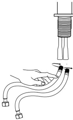
Raccordez les tuyaux d'alimentation tressés au robinet et main bien serrée.
