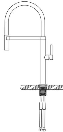
Placez le robinet sur la surface d'installation. Installez les tuyaux flexibles dans le trou du comptoir ou de l'évier.
