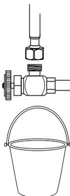
Avant de connecter le tuyau d'alimentation, rincez les vannes d'alimentation pour éliminer tout débris. Placez un seau sous les vannes et faites couler de l'eau pendant 5 à 10 secondes. Coupez l'eau.
