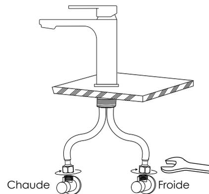
Raccordez les conduites d'eau chaude et froide au tuyau d'entrée et serrez-les fermement à l'aide d'une clé. Ne pas trop serrer.
