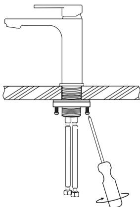
Serrez l'écrou de montage avec les vis jusqu'à ce que le robinet soit fermement fixé.
