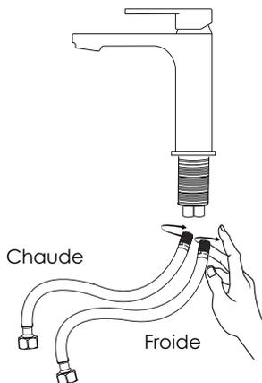
Installez les conduites d'eau chaude et froide jusqu'au robinet. Serrez fermement les tuyaux à la main.
