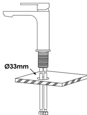
Assurez-vous d'avoir un trou traversant de Ø33mm sur le comptoir. Positionnez et insérez le robinet dans le trou du comptoir prévu à cet effet.
