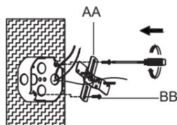
3. Dégarnir une longueur de 254 mm (3/4") d'isolant de l'extrémité des fils du luminaire. Réunir et entortiller les deux extrémités dégarnies à l'aide de pinces (non comprises : noir avec noir (alimentation), blanc avec blanc (neutre)). Couper les extrémités. Enrouler le fil de mise à la terre du boîtier de prises de courant autour de la vis verte préassemblée sur la traverse (AA); brancher ensuite le fil de mise à la terre du boîtier de prises de courant au fil de mise à la terre du luminaire.
