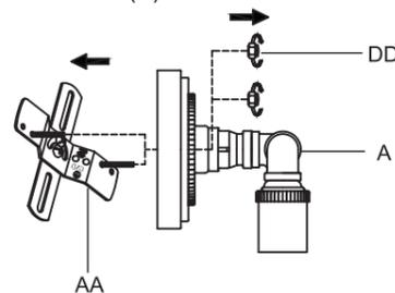
2. Fixer la traverse (AA) au boîtier de prises de courant (non compris) à l'aide des vis du boîtier de prises de courant (BB).
