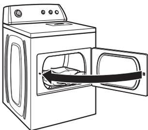
Placer le linge dans la sècheuse. Fermer la porte. Ne pas surcharger la sècheuse; les vêtements doivent pouvoir culbuter librement.
