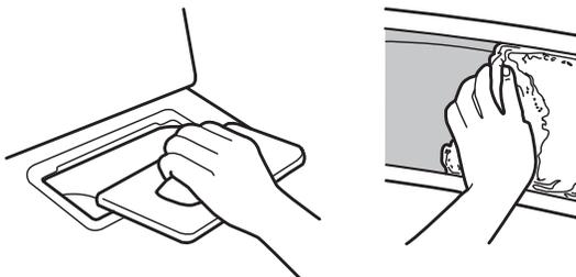
Nettoyer le filtre à charpie avant chaque charge. Enlever le filtre à charpie en le tirant tout droit vers le haut. Enlever la charpie du filtre en la roulant avec les doigts. Ne pas rincer ni laver le filtre pour enlever la charpie. Remettre le filtre à charpie fermement en place.
