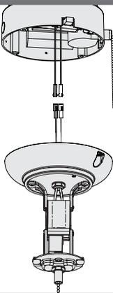
Use los conectores de pin individual para conectar el cable negro o azul del ventilador al cable negro del juego de luz. Conecte el cable blanco del ventilador al cable blanco del juego de luz.
