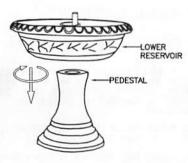
FEED THE PUMP POWER CORD THROUGH THE PLASTIC TUBE TOWARD BOTTOM OF PEDESTAL, CORD EXITS OUT FROM CHANNEL ON THE BOTTOM OF THE BASE.
