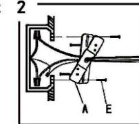
2. Conecte la barra de montaje(A) a la caja de salida usando los tornillos de montaje(E).
