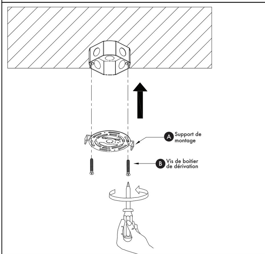
**Fixez le support de montage (A) avec les vis de boîtier de dérivation (B).**
