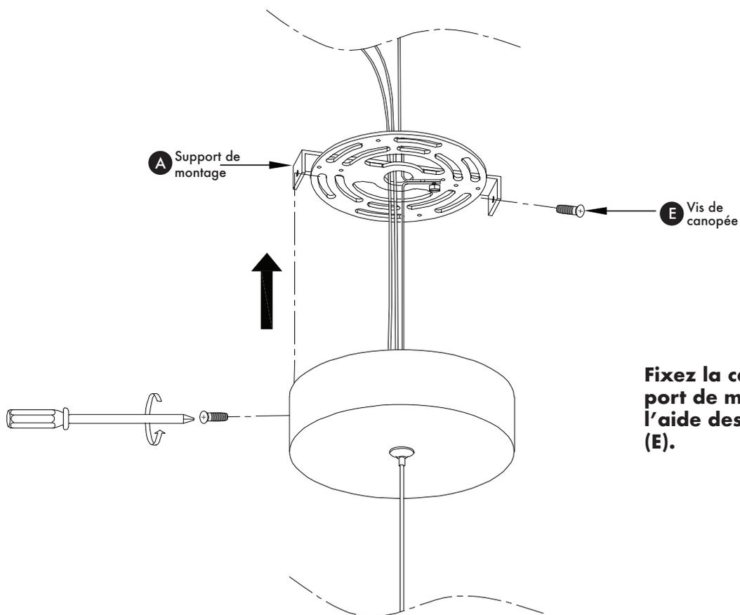
Fixez la canopée au support de montage (A) à l'aide des vis de canopée (E).
