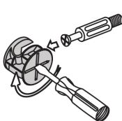
The head of the mini fix housing goes into the open mouth of the mini fix bolt. You then turn the mini fix housing so it tightens over the mini fix bolt.
