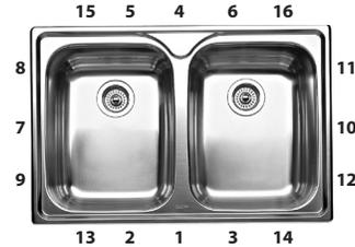
PROPER TORQUE SEQUENCE CHART FOR BLANCO 25" BY 22" STAINLESS STEEL SINKS
