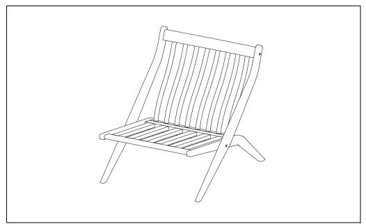
STEP 3 : PUT THE CHAIR UPRIGHT, MAKE SURE ALL LEGS ARE LEVEL AND PRESS THE TOP OF THE SEAT THEN FIRMLY TIGHTEN BOLTS WITH ALLEN KEY (HW6) WHILE THE CHAIR IS UPRIGHT AS PICTURED ABOVE
