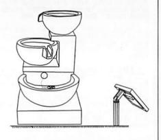
5. TWIST PUMP PLUG SLIGHTLY AND PUSHING IT INTO THE PUMP SOCKET, THEN TWIST LED LIGHT PLUG SLIGHTLY AND PUSHING IT INTO THE LIGHT SOCKET, MAKE SURE THE SEALING RINGS ARE FULLY IN GROOVES.
