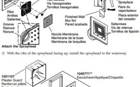
Attacher la face du vaporisateur Instale la placa exterior del rociador
