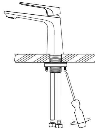
Serrez l'écrou de montage avec les vis jusqu'à ce que le robinet soit fermement fixé.
