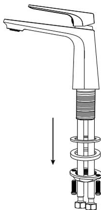
Retirez la rondelle et l'écrou de montage.
