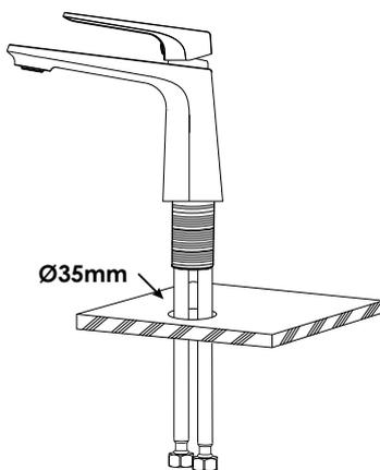
Assurez-vous d'avoir un trou traversant de Ø35mm sur le comptoir. Positionnez et insérez le robinet dans le trou du comptoir prévu à cet effet.
