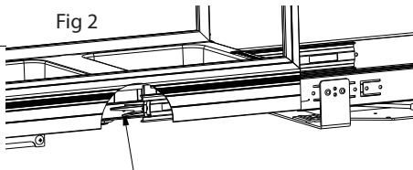
Presionar la palanca para soltar detrás del borde lateral y deslice hacia arriba ó abajo dependiendo del lado. La pieza se separará cuando las dos palancas se desenganchen.
