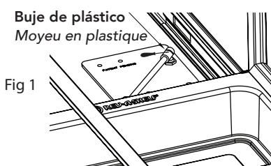
Para ajustes horizontales, afloje las 4 tuercas de 3/8" y mueva a la posición deseada.
