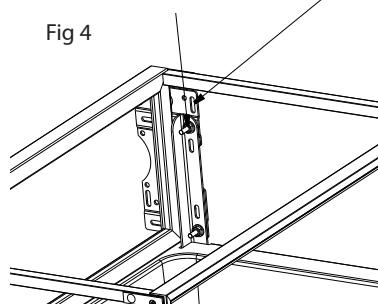
Utilice ranuras verticales para el ajuste vertical de la puerta.
