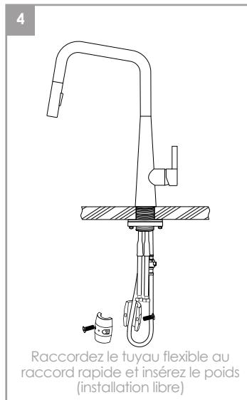
Raccordez le tuyau flexible au raccord rapide et insérez le poids (installation libre)
