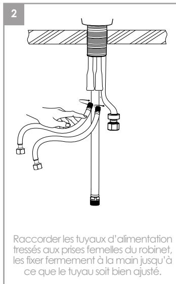
Raccorder les tuyaux d'alimentation tressés aux prises femelles du robinet, les fixer fermement à la main jusqu'à ce que le tuyau soit bien ajusté.
