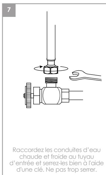
Raccordez les conduites d'eau chaude et froide au tuyau d'entrée et serrez-les bien à l'aide d'une clé. Ne pas trop serrer.
