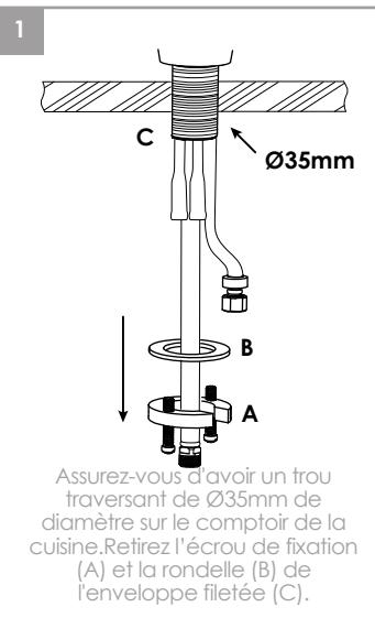
Assurez-vous d'avoir un trou traversant de Ø35mm de diamètre sur le comptoir de la cuisine. Retirez l'écrou de fixation (A) et la rondelle (B) de l'enveloppe filetée (C).
