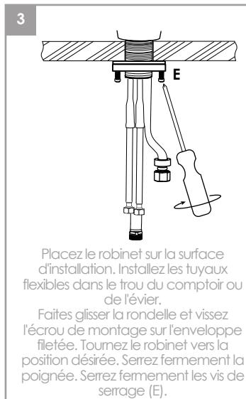
Placez le robinet sur la surface d'installation. Installez les tuyaux flexibles dans le trou du comptoir ou de l'évier.
