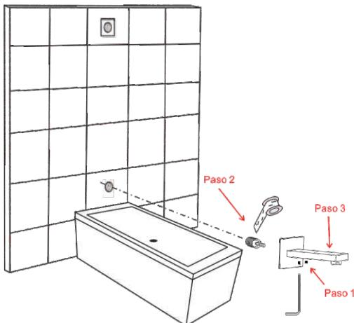
Paso 1: Retire los tornillos en la parte inferior del grifo de la bañera y quite el conector de cobre.
