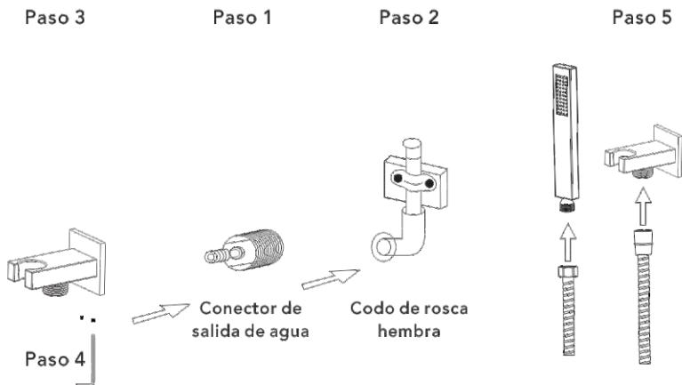
Paso 1. Retire el conector macho de la parte superior del soporte de la ducha (no dañe la junta, de lo contrario, habrá fugas).
