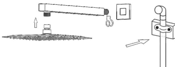
1. Conecte el brazo de la ducha con la cubierta antes de atornillar el brazo en la conexión del elevador con prevenir el daño.
