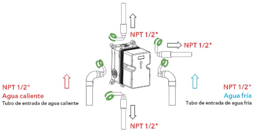
1. Como se muestra en la figura, las tuberías de entrada y salida están pre-enterradas. Por favor, preste atención a la dirección correcta al instalar el cuerpo principal pre-enterrado.
