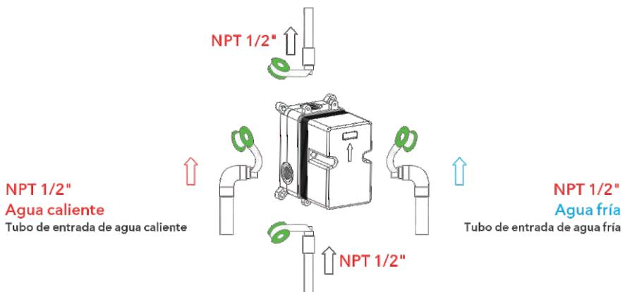
1. Como se muestra en la figura, las tuberías de entrada y salida están pre-enterradas. Por favor, preste atención a la dirección correcta al instalar el cuerpo principal pre-enterrado.
