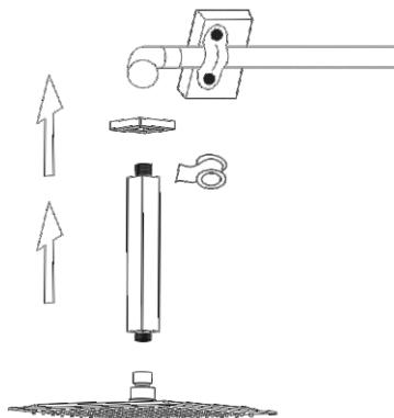
1. Conecte el brazo de la ducha con la cubierta antes de atornillar el brazo en la conexión del elevador con prevenir el daño.
