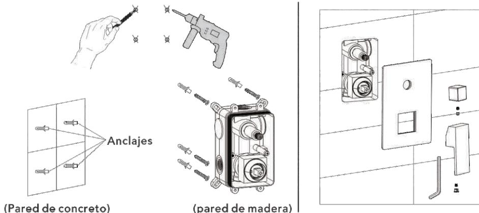
1. Marque según el tamaño de la válvula del cuerpo principal y luego perfore para colocar los anclajes en la pared (pared de concreto).
