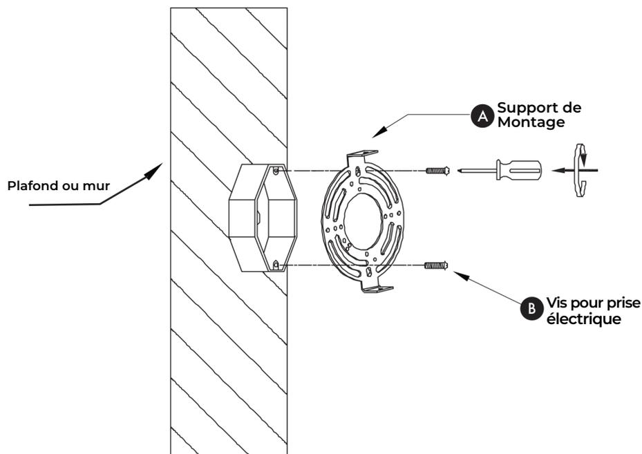
Fixez le support de fixation (A) à l'aide des vis de sortie (B).
