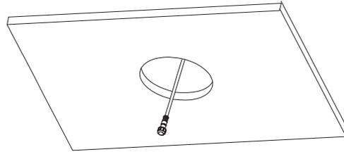
2. Tirez les câbles d'alimentation de l'édifice par l'ouverture du plafond et ouvrez la porte du boîtier du luminaire. Retirez l'enveloppe défonçable du logement et connectez les câbles de l'édifice à l'alimentation dans le logement à l'aide du connecteur approprié.
