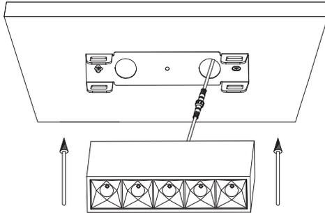
7. Connectez le câble CC entre le corps du luminaire et le boîtier du pilote. Placez le câble CC dans l'ouverture découpée dans le plafond. Fixez solidement le corps du luminaire au support de fixation
