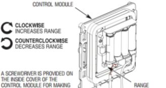
THE INSIDE COVER OF THE CONTROL MODULE FOR MAKING RANGE ADJUSTMENTS
