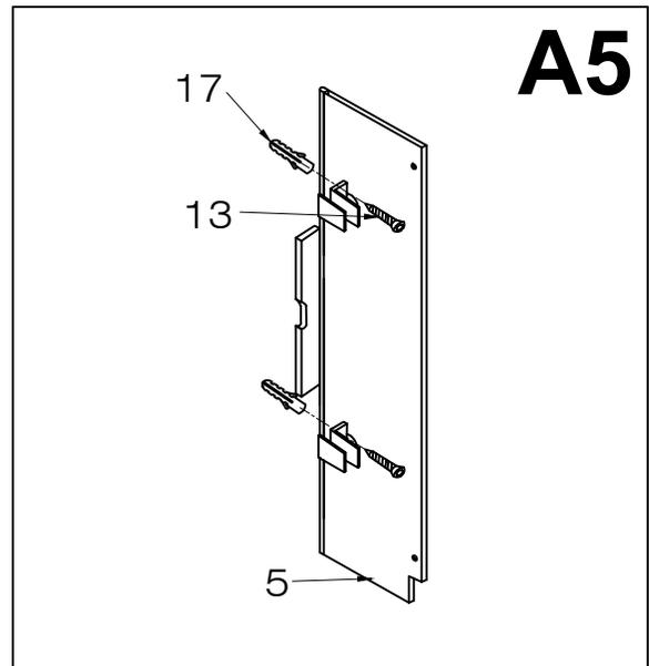
**B. INSTALLING THE TURNING HINGE BASE**
