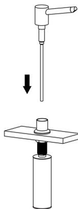
Le distributeur peut maintenant être rempli de savon par le haut, puis une paille peut être insérée dans le distributeur de savon.
