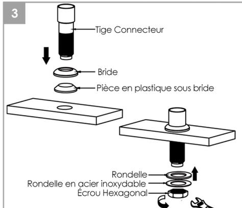
Introduisez la tige de connexion dans le trou, assurez-vous que la bride et le caoutchouc plastique se trouvent au-dessus du comptoir. Fixez la tige de connexion avec un écrou hexagonal, et serrez fermement avec une clé.
