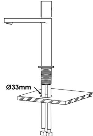
Assurez-vous d'avoir un trou traversant de Ø33mm sur le comptoir. Positionnez et insérez le robinet dans le trou du comptoir prévu à cet effet.
