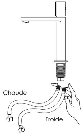
Installez les conduites d'eau chaude et froide jusqu'au robinet. Serrez fermement les tuyaux à la main.
