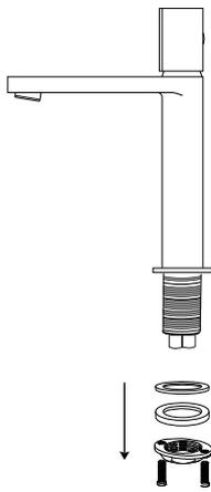
Retirez la rondelle et l'écrou de montage.
