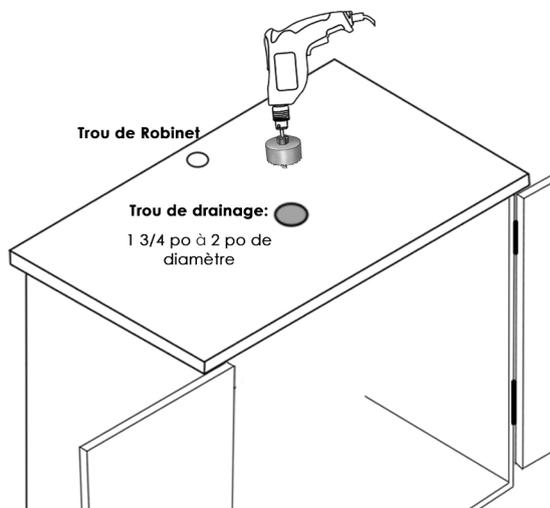
Percez un trou de drainage sur le comptoir, la taille recommandée du trou de drainage est de 1 -3/4 pouces à 2 pouces.
