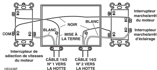
Installer les 2 interrupteurs à bascule inclus à un emplacement pratique pour l'utilisateur. Utiliser deux câble 14/2 pour connecter les interrupteurs à la hotte (voir le diagramme ci-dessus).
