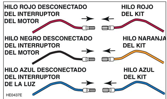
❻ Vuelva a instalar el panel frontal en la campana bloqueando las pestañas de sujeción (una por lado) a la carcasa de la campana. Fije el panel frontal a la campana usando los 4 tornillos de sujeción (dos por lado). Coloca los hilos ROJO, NARANJA y AZUL en el compartimento eléctrico.
