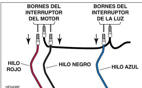
❺ Conecte el hilo ROJO desconectado del borne del interruptor del motor con el hilo ROJO del kit, el hilo NEGRO desconectado del borne del interruptor del motor con el hilo naranja del kit y el hilo AZUL desconectado del borne del interruptor de la luz con el hilo AZUL del kit. Canaliza los hilos sobre la zona del compartimento eléctrico (a través de el agujero a lo largo de los hilos NEGRO y BLANCO).
