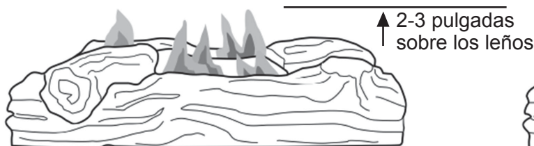
Fig. 22 - Patrón correcto de la llama del quemador
