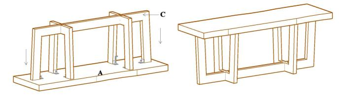
TIGHTEN ALL BOLTS FIRMLY AT THIS TIME USING ALLEN KEY(E). SET BENCH UPRIGHT.
