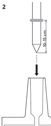
3. Wir empfehlen den Reduktionsring möglichst weit oben im Rohr zu positionieren (s. Illustration).
