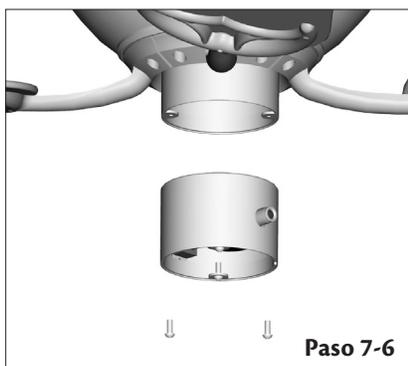
Este ventilador está diseñado para aceptar cualquier dispositivo de iluminación incluido en la lista Hunter. Si decide instalar un dispositivo de iluminación, siga pasos para instalar el adaptador de dispositivo de iluminación incluido y luego siga las instrucciones proporcionadas con el dispositivo de iluminación.
