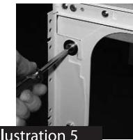
**Étape 6:** Suspendre la porte avec les supports aux vis de montage du produit. Fermement serrer les vis du bas. Bien serrer les vis du haut (avec les rondelles) en laissant un peu de jeu pour des réglages futurs. (Voir l'illustration 5)
