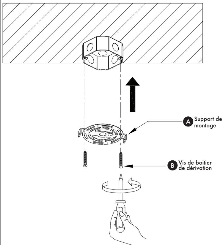
**Fixez le support de montage (A) avec les vis de boîtier de dérivation (B).**
