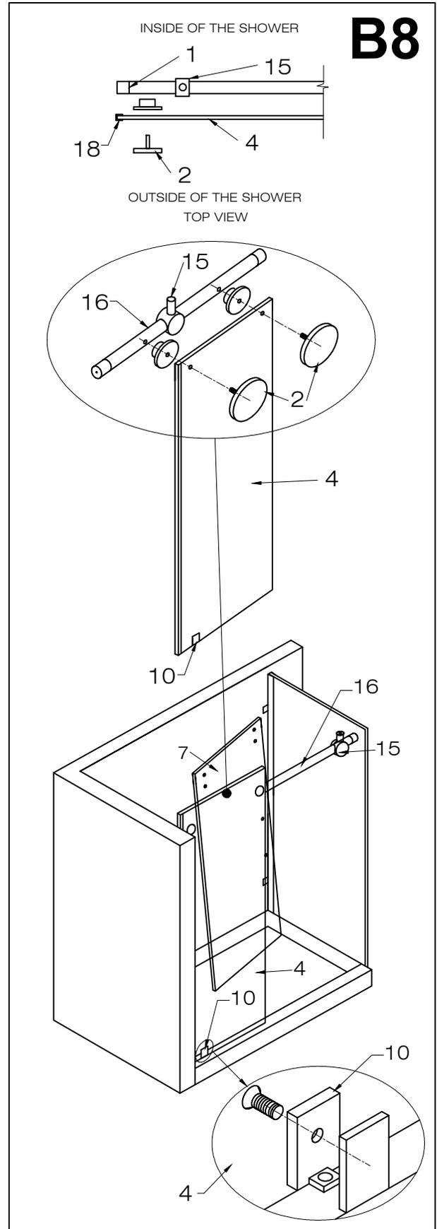
**C. INSTALLING THE SMALL FRONT FIXED PANEL**
