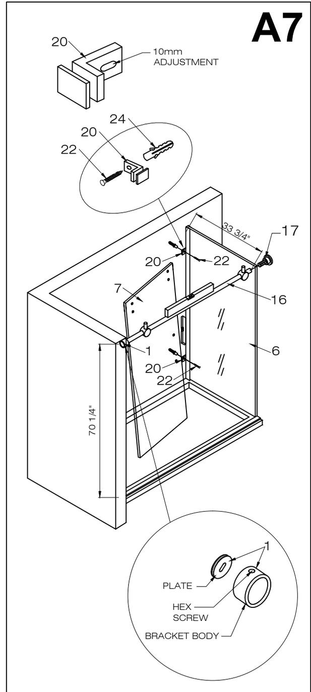
**B. INSTALLING THE BIG FRONT FIXED PANEL**
