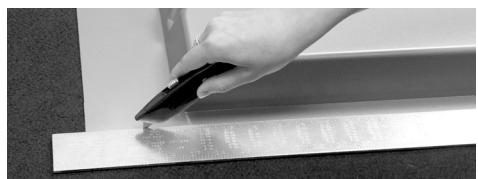
3) Como la bandeja de derrames cabe encima del marco de la cara y en la mayoría de los casos en la columna central, usted necesitará recortar la bandeja de goteo para ajustar la cadena al frente. Puede utilizarse un cuchillo para uso general para hacer los cortes, pero una herramienta eléctrica (segueda, sierra, etc.) podría darle un poco de mejor control.
