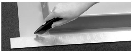
3) Como la bandeja de derrames cabe encima del marco de la cara y en la mayoría de los casos en la columna central, usted necesitará recortar la bandeja de goteo para ajustar la cadena al frente. Puede utilizarse un cuchillo para uso general para hacer los cortes, pero una herramienta eléctrica (segueta, sierra, etc.) podría darle un poco de mejor control.
