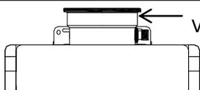
Fixez la pièce de ventilation connectée sur le chauffe-eau avec une vis autotaraudeuse dans le trou situé au dessus du collecteur de condensat.
