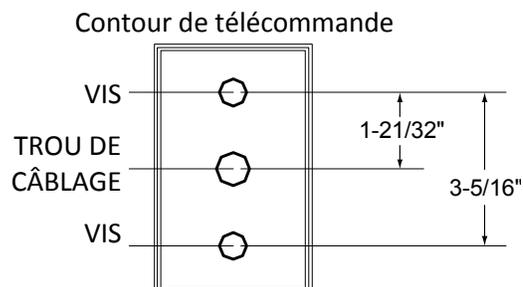
2. Exécutez le câble entre le contrôleur et le chauffe-eau ou le contrôleur et un autre contrôleur
