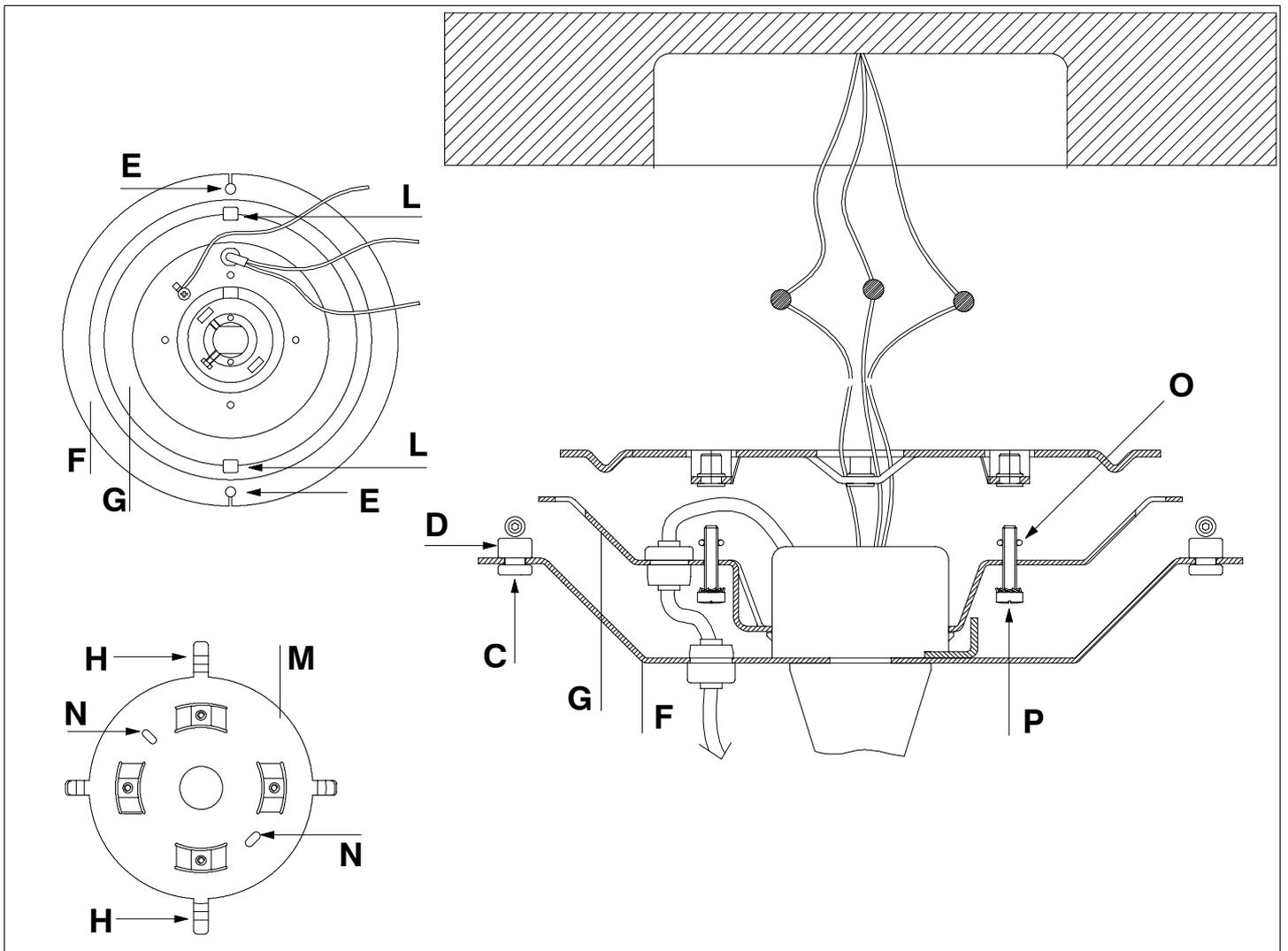
En tenant le boîtier **F**, faire tourner (dans un sens ou dans l'autre) le disque **G** jusqu'au bout. De cette façon, les deux trous, situés sur le boîtier **F**, coïncident avec les positions des deux vis, situées sur le disque **G**. Placer le culot **M** sur le disque **G**, en faisant en sorte que les deux ailettes métalliques les plus longues **H** coïncident parfaitement avec les ouvertures **L**.
