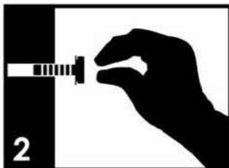
2 Positionnez correctement chacune des pièces et insérez les vis dans leurs orifices respectifs. Puis serrer à la main seulement jusqu'à 70 %. Resserrement complète avec les outils viendrez à une étape ultérieure.
