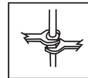
Serrez la connexion avec deux clés anglaises pour empêcher des dommages au corps du tuyau. Faites attention de ne pas plier la tige, puisque ceci annulera la garantie du produit.
