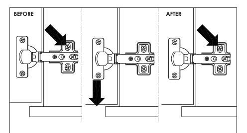
**STEP 15.1.2.** IF THE GAP ON THE BOTTOM IS TOO WIDE THEN SLIDE THE DOOR SLIGHTLY TO THE BOTTOM.
