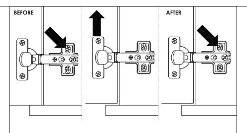
**STEP 15.1.1.** IF THE GAP ON THE TOP IS TOO WIDE THEN SLIDE THE DOOR SLIGHTLY TO THE TOP.
