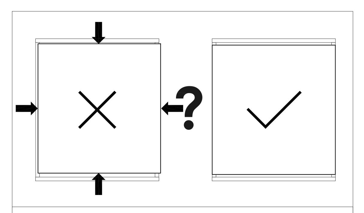
STEP 14 THE GAPS AND EDGES AROUND THE DOOR SHOULD BE BALANCED. IF THE GAPS ARE NOT BALANCED, PLEASE FOLLOW STEPS 15 THROUGH 17.
