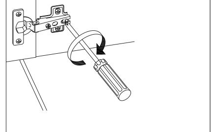
**STEP 16.2.** TIGHTEN THE BACK CENTER SCREW.
