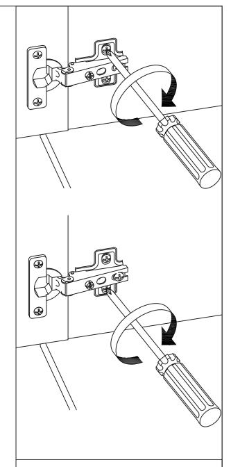
**STEP 15.2.** TIGHTEN BOTH HINGE BASE SCREWS.
