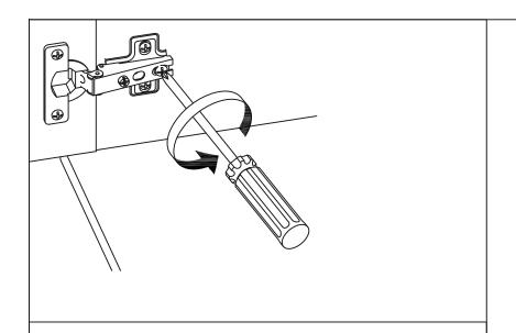
**STEP 16.1.** IF THE EDGE ON THE LEFT OR RIGHT ARE NOT BALANCE, LOOSEN THE BACK CENTER SCREW.
