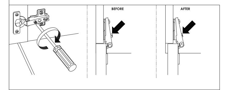
**STEP 16.1.2.** IF THE EDGE ON THE LEFT SIDE IS TOO NARROW, YOU WILL NEED TO SLIDE THE DOOR SLIGHTLY TO THE RIGHT BY TURNING THE FRONT CENTER SCREW CLOCKWISE.
