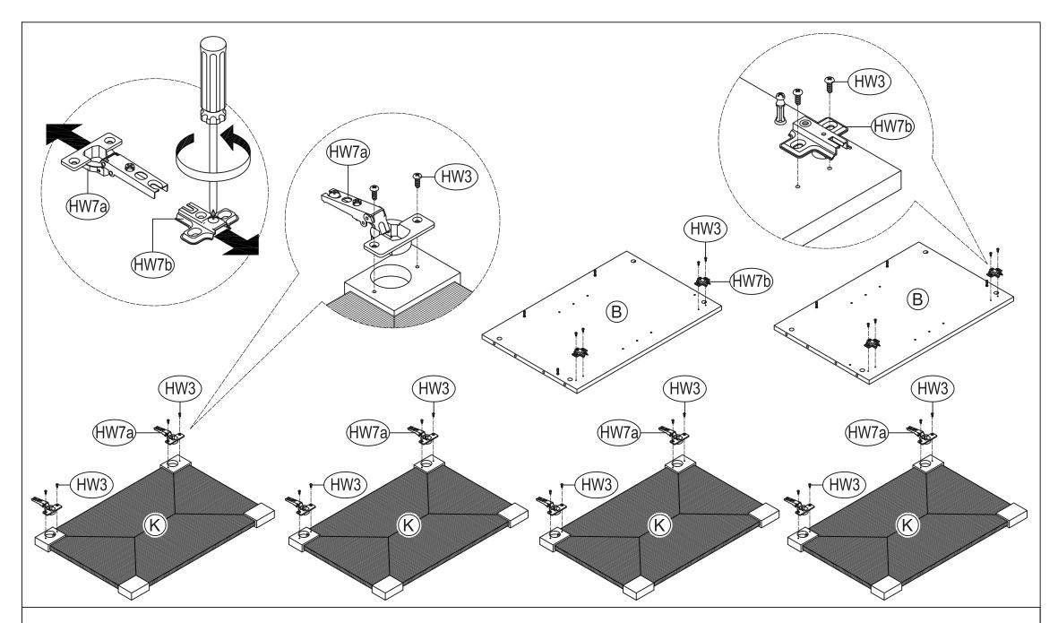
STEP 2 DETACH THE HINGE FROM THE BASE. ATTACH HINGE BASES (HW7b) TO SIDE PANELS (B) USING ROUND HEAD SCREWS 13MM (HW3). ATTACH HINGES (HW7a) TO DOORS (K) USING ROUND HEAD SCREWS 13MM (HW3).
