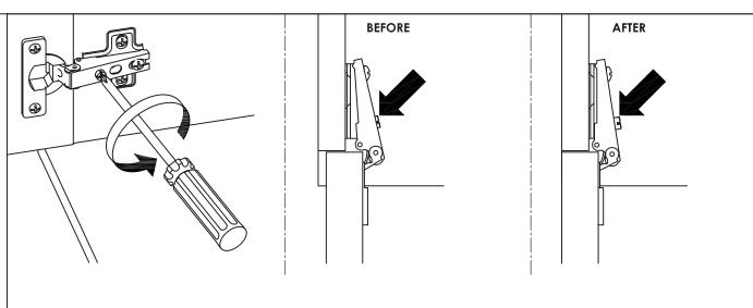
**STEP 16.1.1.** IF THE EDGE ON THE LEFT SIDE IS TOO WIDE, YOU WILL NEED TO SLIDE THE DOOR SLIGHTLY TO THE LEFT BY TURNING THE FRONT CENTER SCREW COUNTER CLOCKWISE.
