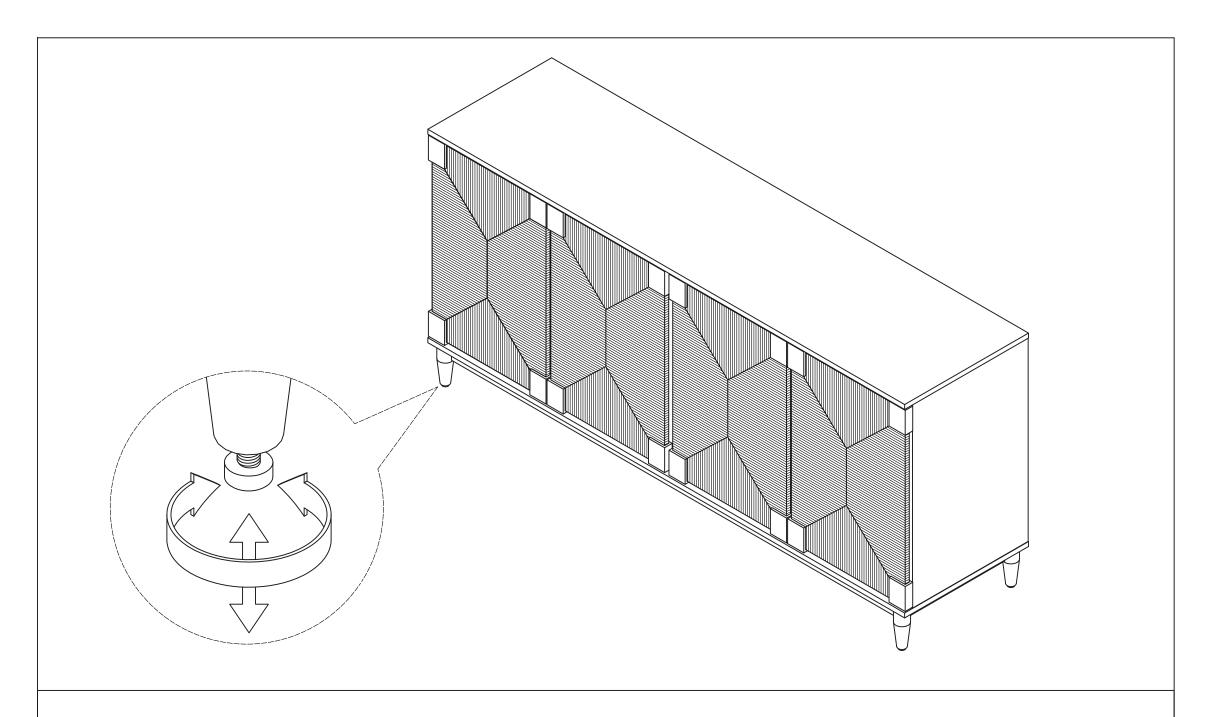
STEP 22 ADJUST THE ADJUSTER THAT HAS ALREADY BEEN ASSEMBLED TO THE LEGS TO STABILIZE YOUR UNIT.
