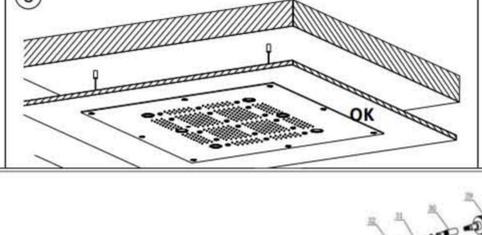
Fijar la ducha (1) a la placa mediante los tornillos correspondientes, utilizando el adaptador especial (S) para el ajuste correcto.
