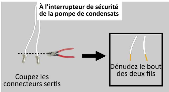
5. Utilisez des serre-fils ou des connecteurs approuvés pour connecter les fils vers l'interrupteur de sécurité aux contacts normalement ouverts de la pompe de condensats (voir l'illustration ci-dessous).
