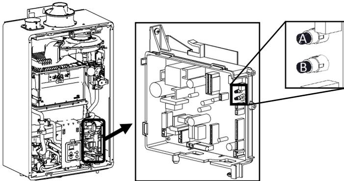
4. Utilisez ▲ (haut) et ▼ (bas) sur le contrôleur pour sélectionner un paramètre (voir le tableau de réglage des paramètres ci-dessous).
