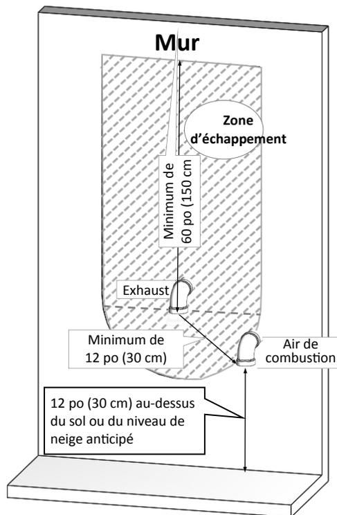
Embout d'air de combustion interdit dans la zone ombrée
