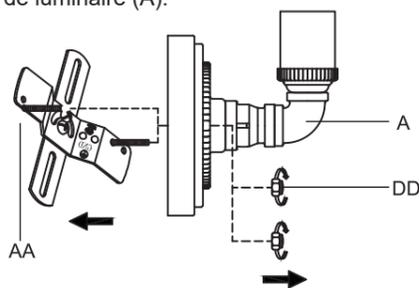
2. Fixer la traverse (AA) au boîtier de prises de courant (non compris) à l'aide des vis (BB) du boîtier de prises de courant.
