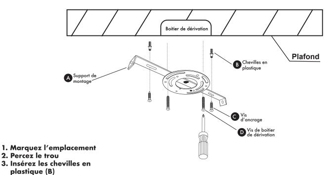
4. Fixez le support de montage (A) les vis de boitier de dérivations (D) et les vis d'ancrage (C). Étape 3. Connecter les fils
