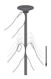
La longueur du câble est réglable. Pour déterminer la longueur appropriée du luminaire, maintenez la canopée du luminaire contre le boîtier de dérivation au plafond pour ajuster le câble.
