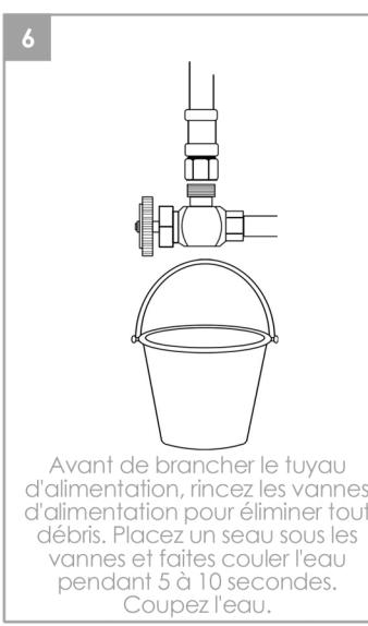
Avant de brancher le tuyau d'alimentation, rincez les vannes d'alimentation pour éliminer tout débris. Placez un seau sous les vannes et faites couler l'eau pendant 5 à 10 secondes. Coupez l'eau.
