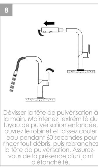
Dévisser la tête de pulvérisation à la main. Maintenez l'extrémité du tuyau de pulvérisation enfoncée, ouvrez le robinet et laissez couler l'eau pendant 60 secondes pour rincer tout débris, puis rebranchez la tête de pulvérisation. Assurez-vous de la présence d'un joint d'étanchéité.
