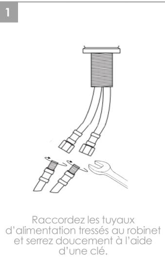
Raccordez les tuyaux d'alimentation tressés au robinet et serrez doucement à l'aide d'une clé.
