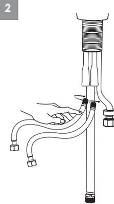
Raccorder les tuyaux d'alimentation tressés aux prises femelles du robinet, les fixer fermement à la main jusqu'à ce que le tuyau soit bien ajusté.
