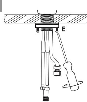
Placez le robinet sur la surface d'installation. Installez les tuyaux flexibles dans le trou du comptoir ou de l'évier.
