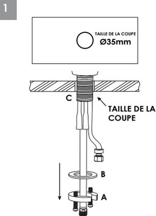
Assurez-vous d'avoir un trou traversant de Ø35mm de diamètre sur le comptoir de la cuisine. Retirez l'écrou de fixation (A) et la rondelle (B) de l'enveloppe fileté (C).
