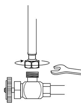
Raccordez les conduites d'eau chaude et froide au tuyau d'entrée et serrez-les bien à l'aide d'une clé. Ne pas trop serrer.
