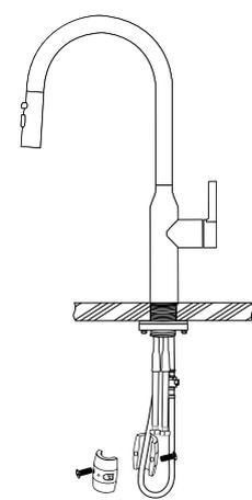
Raccordez le tuyau flexible au raccord rapide et insérez le poids (installation libre)
