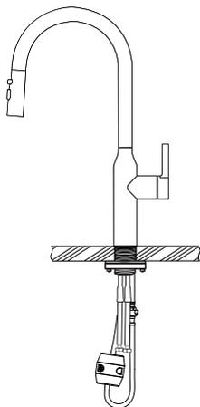
Fixer le poids sur le point vertical le plus bas du côté du tuyau extensible. (pas du côté de la connexion rapide).
