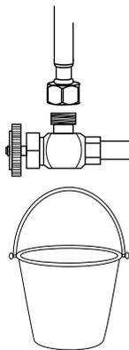
Avant de brancher le tuyau d'alimentation, rincez les vannes d'alimentation pour éliminer tout débris. Placez un seau sous les vannes et faites couler l'eau pendant 5 à 10 secondes. Coupez l'eau.
