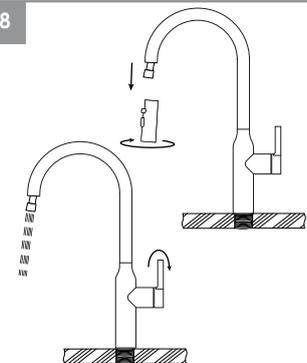
Dévisser la tête de pulvérisation à la main. Maintenez l'extrémité du tuyau de pulvérisation enfoncée, ouvrez le robinet et laissez couler l'eau pendant 60 secondes pour rincer tout débris, puis rebranchez la tête de pulvérisation. Assurez-vous de la présence d'un joint d'étanchéité.
