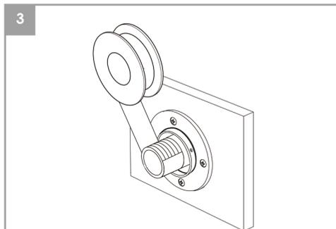
Envelopper la partie filetée exposée du tuyau avec du ruban de téflon.
