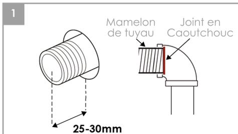
Insérer et serrer le mamelon dans le mur, utiliser la longueur du mamelon en fonction de l'épaisseur du mur et de la profondeur du mur, un mamelon est inclus mais le plombier peut avoir besoin d'utiliser une taille différente. Il est recommandé d'utiliser un joint en caoutchouc pour une étanchéité efficace.
