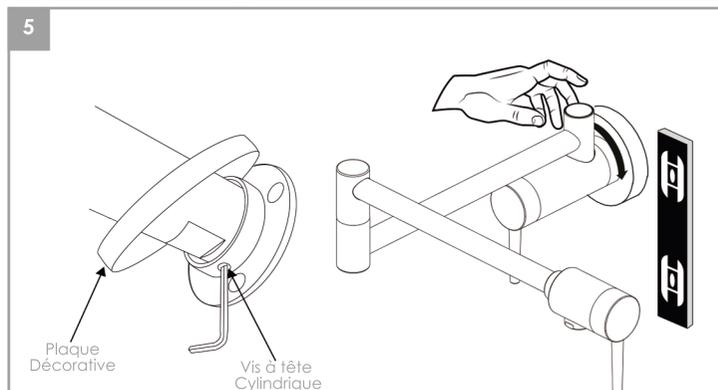
Mettez le bras de remplissage du pot à niveau et serrez la vis à tête cylindrique à l'aide d'une clé Allen, puis faites glisser et enclenchez la plaque décorative.
