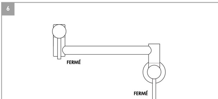
Avec les deux poignées de remplissage du pot en position fermée, ouvrir l'alimentation en eau.
