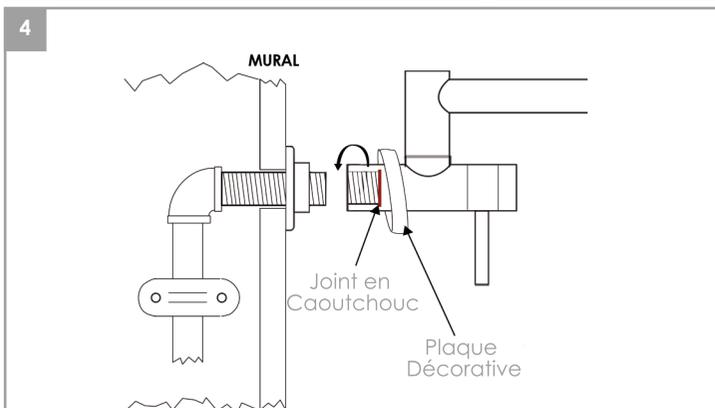
Insérer le joint en caoutchouc dans la base de la cavité du robinet, puis visser le robinet sur le tuyau exposé.
